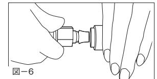
②次にホースのソケットと本機のプラグを接続します。接続時はトリガに指をかけずにしっかりと持ち、ホース側のソケットをまっすぐに押しあせてください。カチッと音がしたら接続完了です。（図-7）
