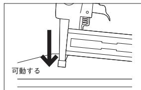
③図-3の様に射出口側に押してください。射出側に隙間なく入れてください。
